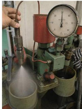
Gambar 8. Pemeriksaan Pressure Injector.
