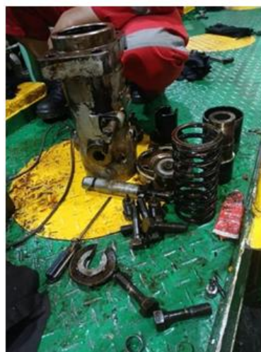
Gambar 5. Injection Fuel Pump Setelah Dioverhaul.
