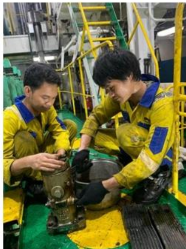
Gambar 7. Injection Fuel Pump setelah Dioverhaul.
